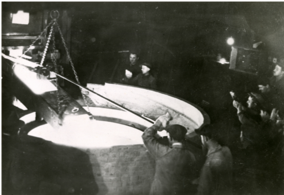
Coulée d'un disque de télescope, 1938 © DR / Archives de Saint-Gobain
