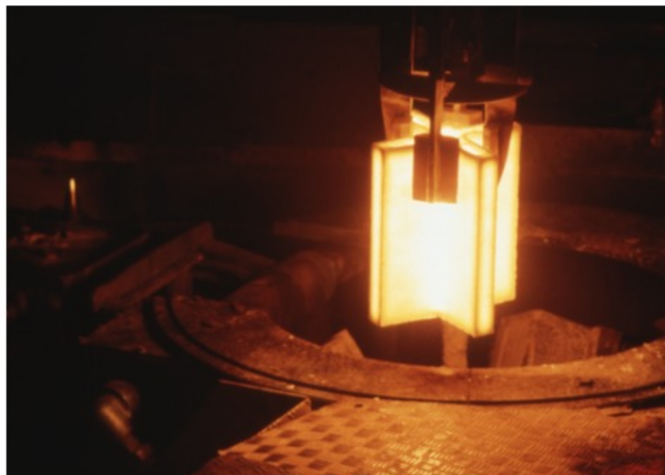
Extraction d'une brique Cruciform® incandescente après le coulage à l'usine du Pontet, 1989 © Studio Pons / DR / Archives de Saint-Gobain
