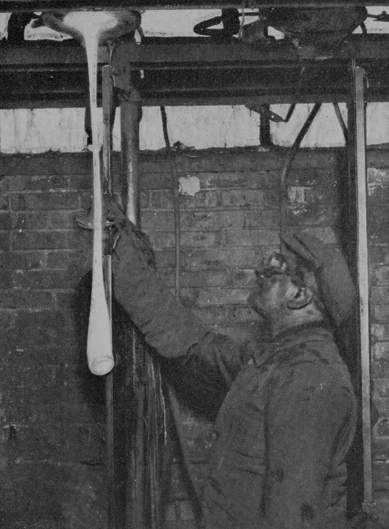
Un ouvrier règle la vitesse de l'étreuse pour obtenir le diamètre désiré chez Quartz en 1927 © DR / Archives de Saint-Gobain
