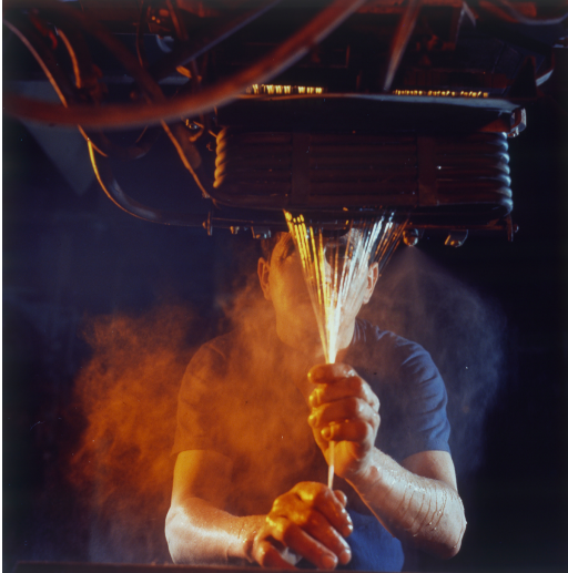
Fabrication du fil de verre à l'usine Vetrotex de Chambéry : étirage du fil par un ouvrier en sortie de filière © DR / Archives de Saint-Gobain
